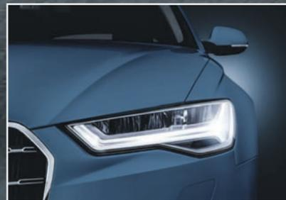
Светодиодные фары Audi Matrix\*\* восхищают не только прогрессивным дизайном. Они анализируют окружающую обстановку и регулируют яркость потока света с помощью автономно управляемых светодиодов, помогая вам лучше ориентироваться на дорогах и предотвращать аварийные ситуации.
